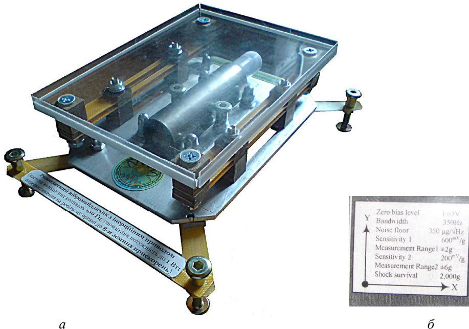
Рис. 19. Експериментальний зразок вібромайданчика з інерційним приводом (а) та давач, що приєднувався до маси m_1 (б)
