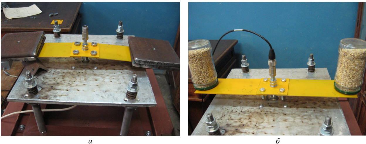
Рис. 9. Експериментальна установка: а – для дослідження РЗ за різних частот; б – для дослідження динаміки зерна в бункері
