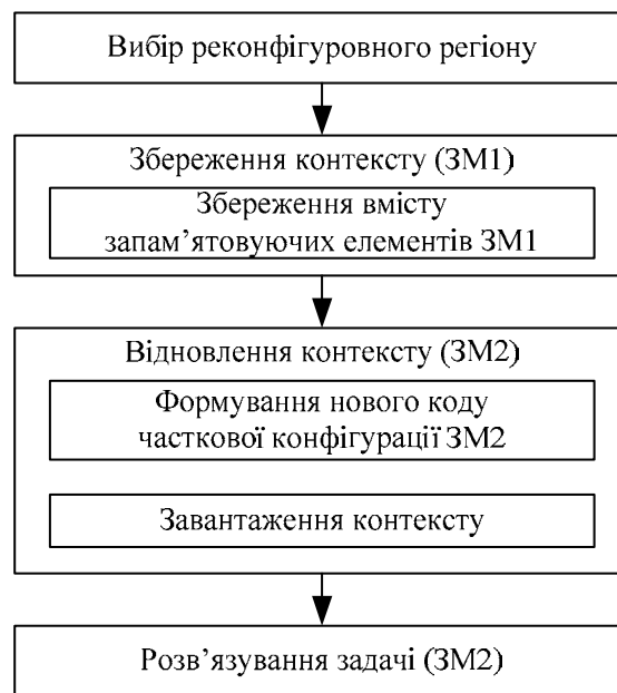
Рис. 3. Послідовність дій для перемикання контексту в разі реалізації апаратної багатозадачності в ЧР ПЛІС
