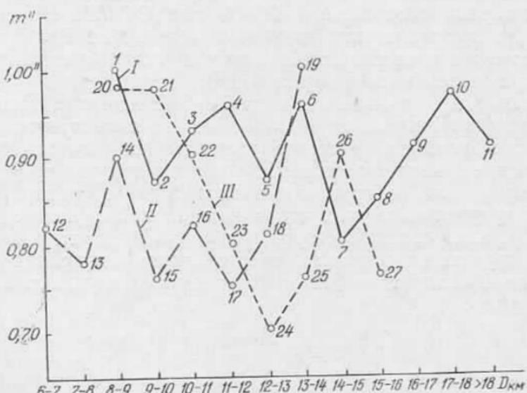
График зависимости точности угловых измерений от длины сторон треугольников:
