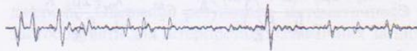
Рис 4. Обмінні хвилі в другому випадку для різних значень гідростатичного стиску P = 0 МПа, 8 МПа, 15 МПа.
