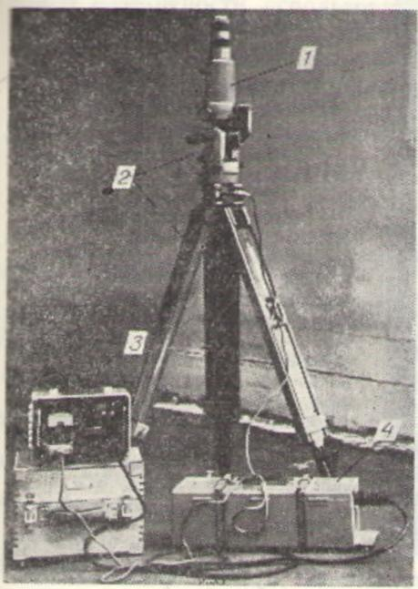
Рис. 1. Гиротеодолит Gi-C2;
