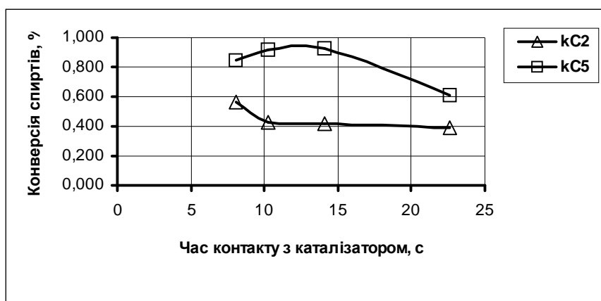
Рис. 3. Залежність конверсії етилового та ізоамілового спиртів від часу контакту з каталізатором за їх співвідношення 1:2 і температури 593 К
