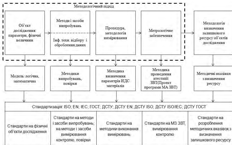
Рис. 2. Структура ідеології визначення параметрів напружено-деформованого стану матеріалів
