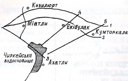
Рис.2. Схема розташування глибинних розломів в районі Чиркейського водосховища: 1- Пшениш – Тирнаузкий; 2- Середній; 3- Ахатли-Зубутлинський; 4- Старий Чиркей-Екібулакський; 5- Ахатли – Кумторкалинський.
