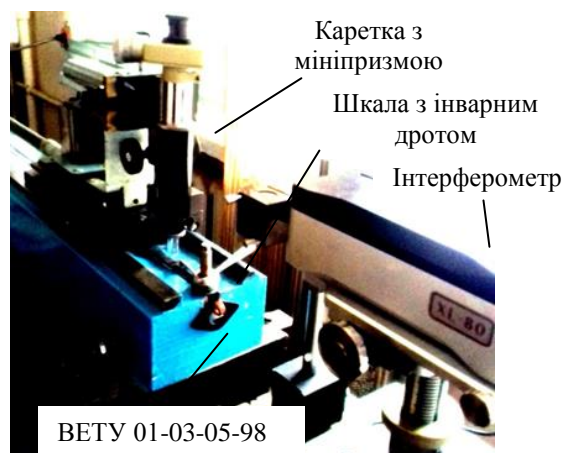
Рис. 9. Компарування 10 м інварного дроту
