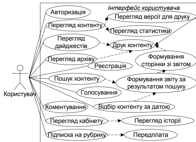
Рис. 5. Діаграма варіантів використання для інтерфейсу з обмеженим доступом користувача до інформаційного ресурсу в системах електронної контент-комерції
