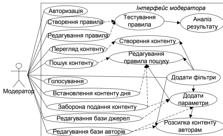
Рис. 8. Діаграма варіантів використання для інтерфейсу модераторів інформаційного ресурсу в системах електронної контент-комерції
