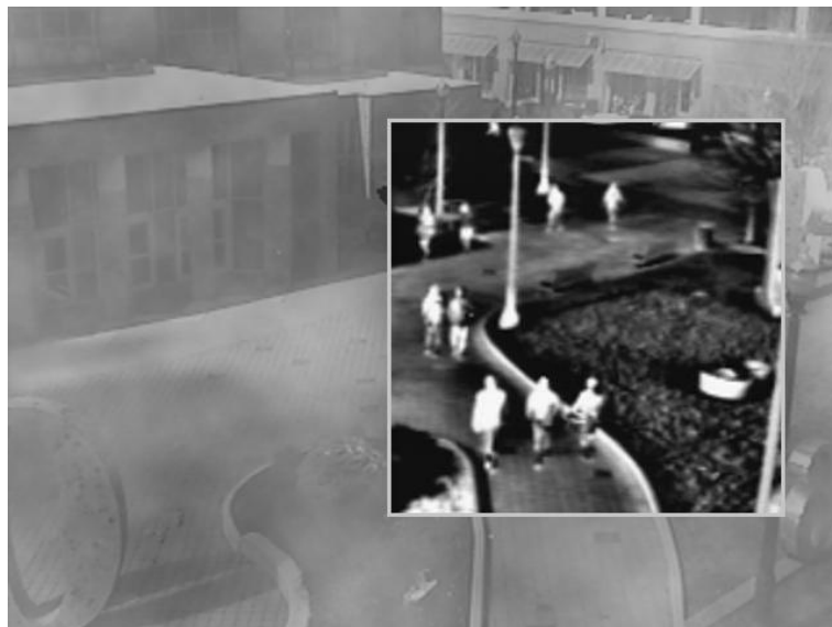
Рис. 4. Результат суміщення телевізійного та тепловізійного зображень за погіршеної видимості у видимому (телевізійному) каналі
