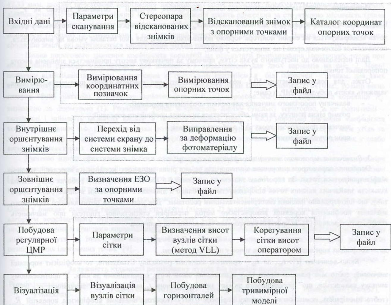
Рис. 1. Технологічна схема автоматизованої побудови регулярної ЦМР
