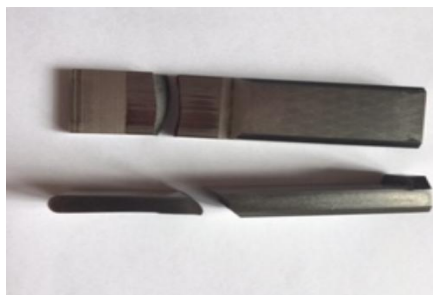
Рис. 3. Зруйновані пуансони конструкції до модернізації
