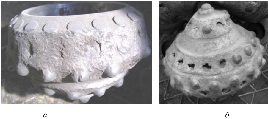
Рис. 1. Загальний вигляд зруйнованого породоруйнівного оснащення на найнавантажениших вінцях шарошки тришарошкового бурового долота 269,9 ОК-ПВ: а – випадання і руйнування породоруйнівної частини твердосплавних зубців та завальцьовування вінця шарошки; б – випадання твердосплавних зубців шарошки
