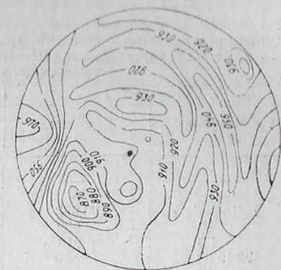
Рис. 2. Линии равных фаз в поперечном сечении светового пучка тахеометра ЕОТ 2000, выраженные в остатках измеряемого расстояния в мм: * — точка, соответствующая максимуму отраженного сигнала.
