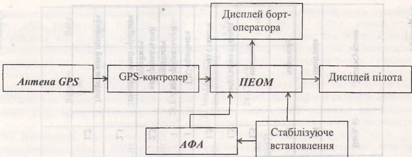
Блок-схема системи ASCOT
