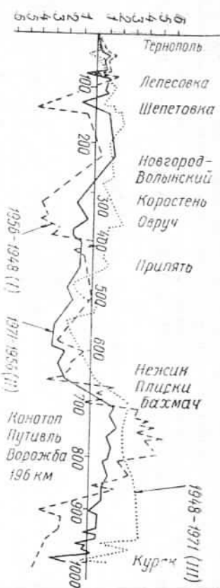
График скоростей вертикальных движений по трассе Тернополь—Курск. I — 1954—1956 гг.; II — 1970—1971 гг.; III — 1948—1971 гг.
