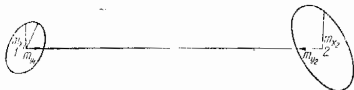
Рис. 2. Два пункта с известными эллипсами погрешностей.
