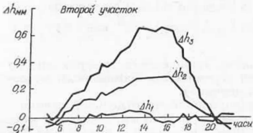
Измерение рефракции в превышениях на протяжении дня при различных методах наблюдений.
