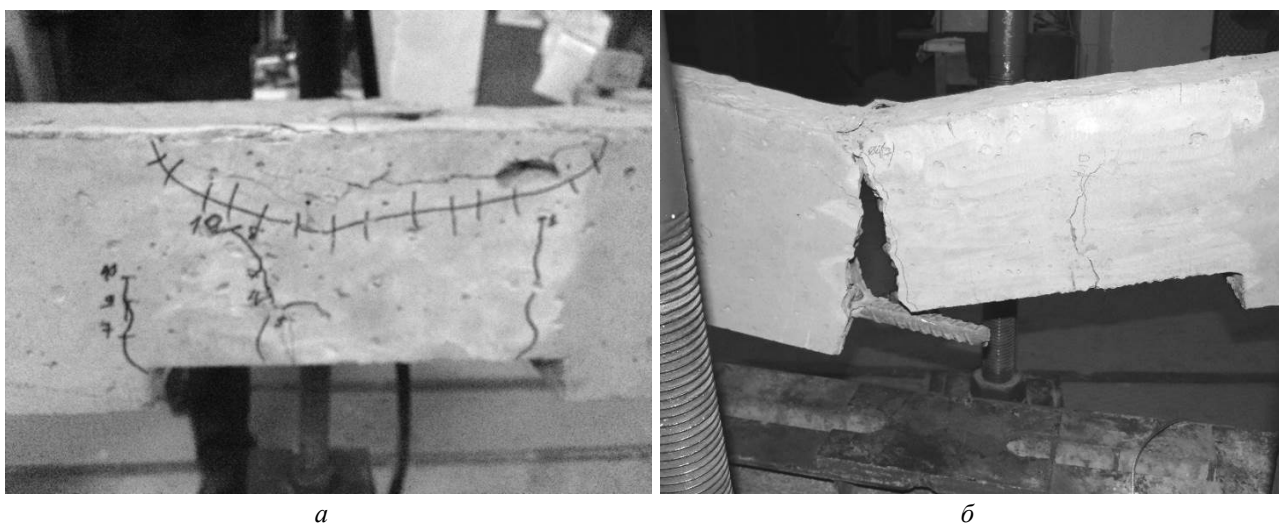
Рис. 6. Характер руйнування дослідних зразків: а – БЗ 2.3; б – БП 2.5-0.3
