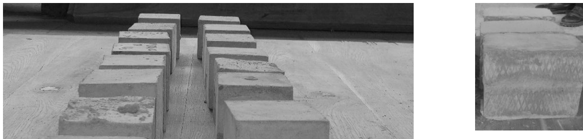
Рис. 2. Зразки для визначення міцнісних характеристик ц/п розчину та цегли
