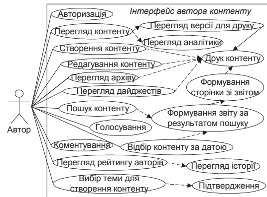
Рис. 7. Діаграма варіантів використання для інтерфейсу авторів контенту до інформаційного ресурсу в системах електронної контент-комерції
