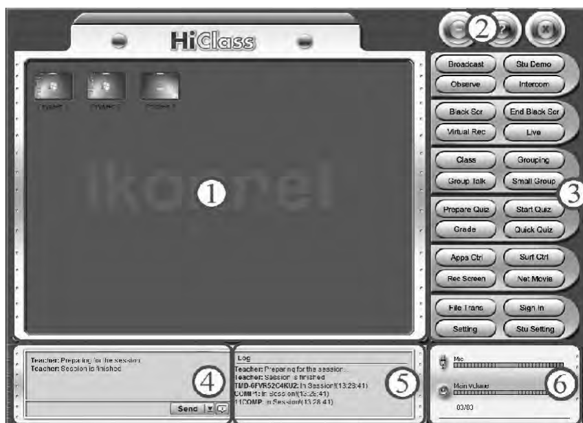
Рис.4. Система управління комп'ютерним класом HI Class: 1 – робоча зона; 2 – елементи керування вікном; 3 – панель інструментів; 4 – вікно чата; 5 – вікно журналу подій; 6 – налаштування звука
