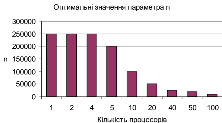
Рис. 2. Оптимальні значення параметра n у випадку “бінарного” закону розподілу ймовірностей звертання до записів, N = 10^6 , d_0/b_0 = 20 та різної кількості процесорів
