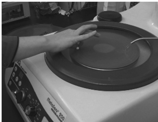
Рис. 5. Підготовка зразка для дослідження в лабораторії Jablonski Building Conservation, Inc.: а – порізка; б – шліфування (фото автора, 2017)
