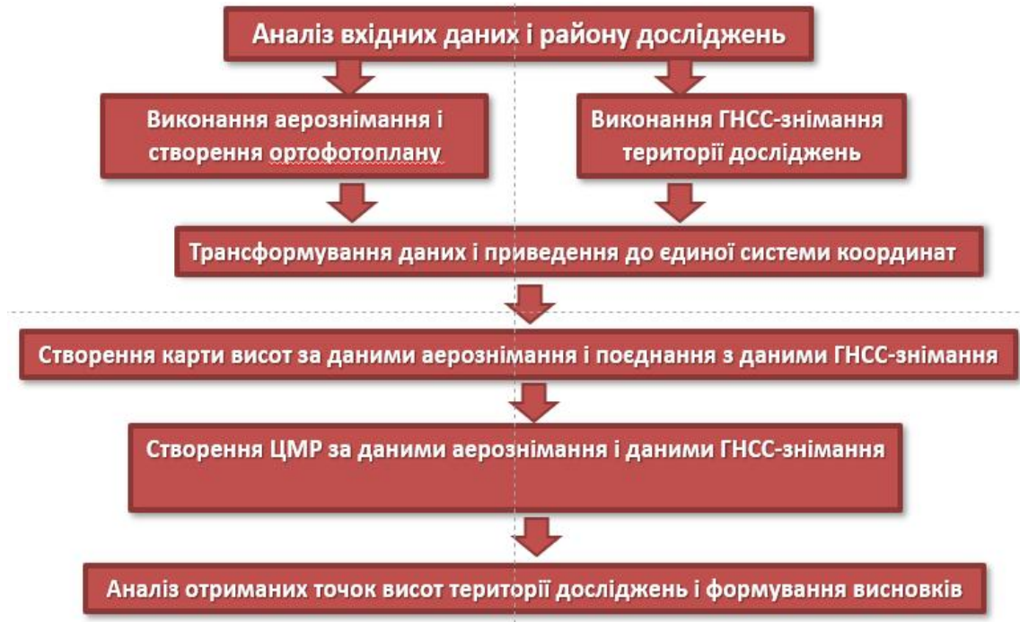
Рис. 5. Технологічна схема визначення висотної похибки ортотрансформування аерознімків
