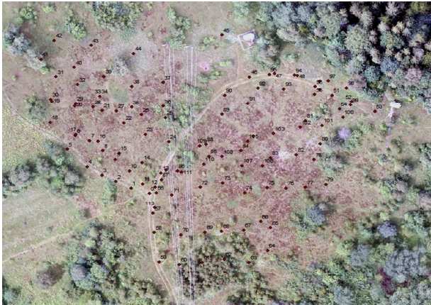
Рис. 8. Ортофотоплан гірської частини смт. Східниця, отриманий у 2018 році з нанесеною мережею точок, отриманих за допомогою ГНСС (всі дані приведені до системи координат WGS84 та Балтійської системи висот)
