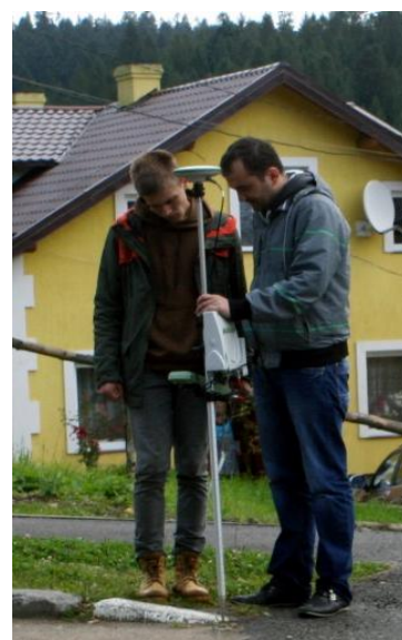
Рис. 4. Процес отримання координат контрольних точок ГНСС-методом
