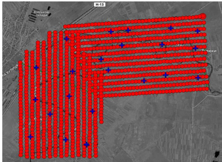
Рис. 4. Центри проєкцій (●) та опорні точки (⊕)
