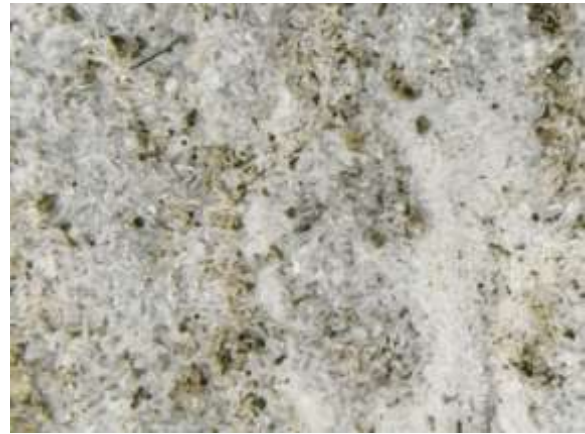
Рис. 4. Мікро-аналіз пофарбованої поверхні алебастру з чаші хрестильниці. Електронний мікроскоп у відбитому світлі, збільшення в 50 р.
