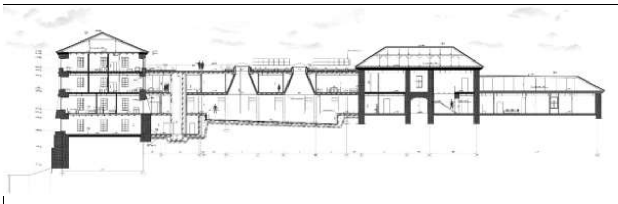
Rys. 21. Przekrój podłużny przez halę basenową (opracowanie własne).
