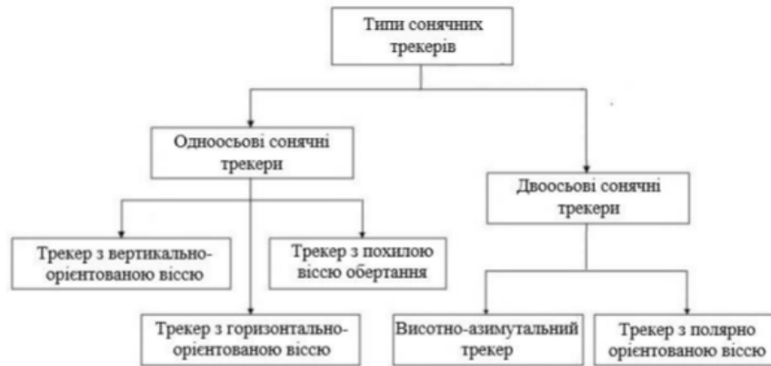
Рис. 4. Класифікація сонячних трекерів
