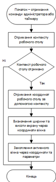
Рис. 2. Схема алгоритму створення знімків робочого столу в ОС Windows
