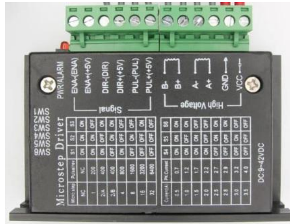
Рис. 4. Драйвер керування Microstep Driver TB6600
