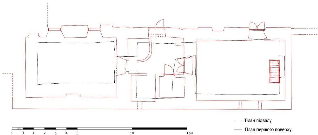
*Рис.9. Співставлення плану підвального приміщення та плану першого поверху корпусу К, обмірне креслення, липень 2022 р., виконали Бастрон С., Косик І., наук. керівники Поліщук Л., Сербін А.*
