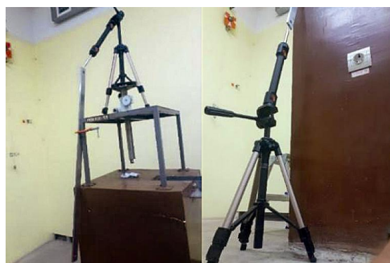
Рис. 15. Перевірка двопризмового вектора кінцевою мірою
