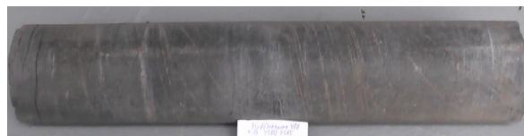
Рис. 3. Щільні вапняки із свердловини 479 Новодиканська, інтервал 4565–4580 м, винос керн 89 %
