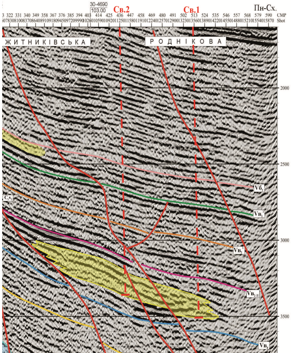
Рис. 8. Фрагмент часового розрізу 18/46/90 через Роднікову і Житниківську структури. За матеріалами Державного підприємства «Укргеофізика». Умовні позначення на рис. 7
