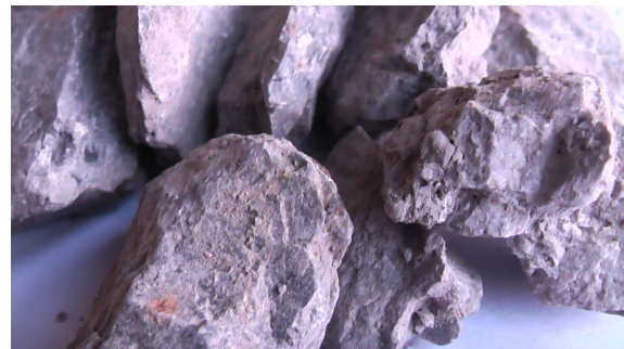
Рис. 2. Адіабатична тріщинуватість вапняків із свердловини 2 Мачуська, інтервал 5247–5262 м, винос керн 17 %
