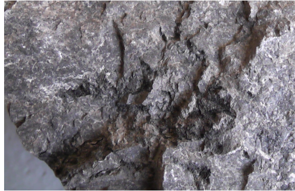
Рис. 1. Адіабатична тріщинуватість вапняків із свердловини 1 Мачуська, інтервал 5197–5214 м, винос керн 25 %
