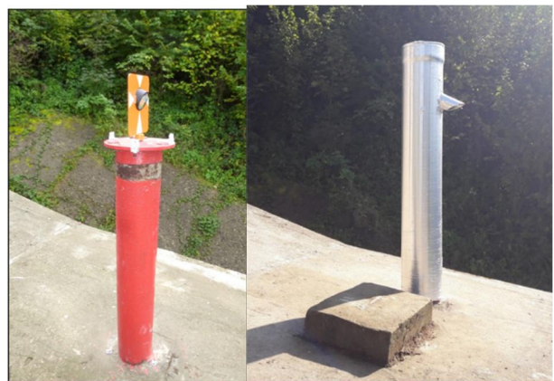
Рис. 5. Відбивач із захисним ковпаком, закріплений на анкерній опорі
