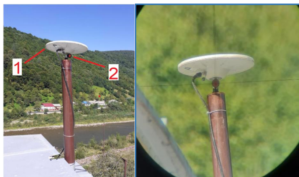
Рис. 8. Перманентна ГНСС-станція TERE: 1 – ГНСС-антена; 2 – призма-відбивач
