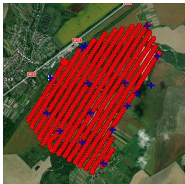
Рис. 4. Схема розташування центрів проєкцій цифрових знімків та точок геодезичної основи 2021 р. знімання
