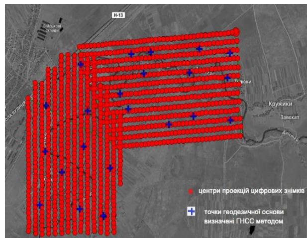
Рис. 3. Схема розташування центрів проєкцій цифрових знімків і точок геодезичної основи 2017 р. знімання
