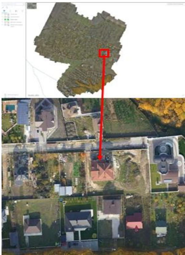
Рис. 9. Ортофотоплани, завантажені в геопортал за результатами аерознімання з БПЛА 2018 р. Внизу збільшений фрагмент
