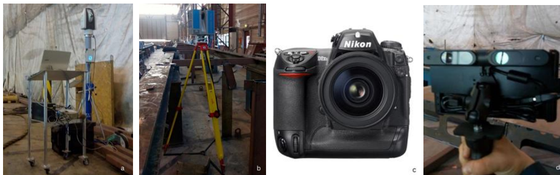
Рис. 2. Використані в дослідженні прилади: Leica Absolute Tracker AT960-LR (a); Z+F Imager 5010 (b); фотоапарат Nikon D2Xs (c); ручний сканер DPI-7 (d)
