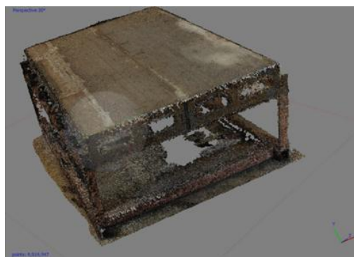
Рис. 4. Згенерована щільна хмара точок на основі результатів промислової фотограмметрії
