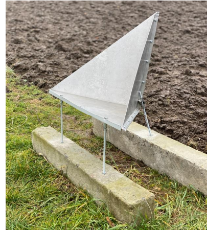
Рис. 1. Трикутний кутовий відбивач із довжиною ребра 0,5 м
