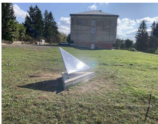
Рис. 5. Трикутний кутовий відбивач з довжиною ребра 1,0 м та захисним екраном, встановлений в м. Бережани
