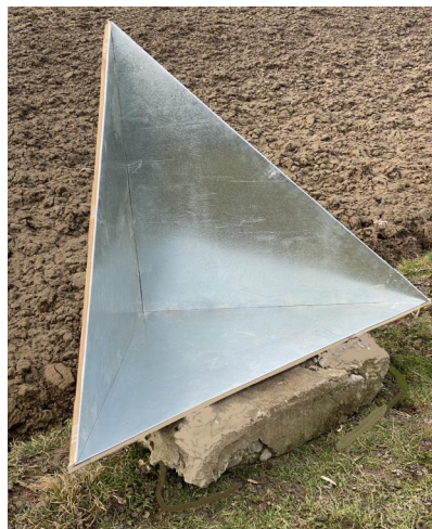
Рис. 3. Трикутний кутовий відбивач з довжиною ребра 1,0 м
