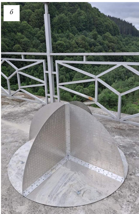
Рис. 7. Круговий чотиригранний кутовий відбивач з довжиною ребра 1,0 м, встановлений на дамбі Тербле-Ріцької ГЕС: а – вигляд 1; б – вигляд 2
