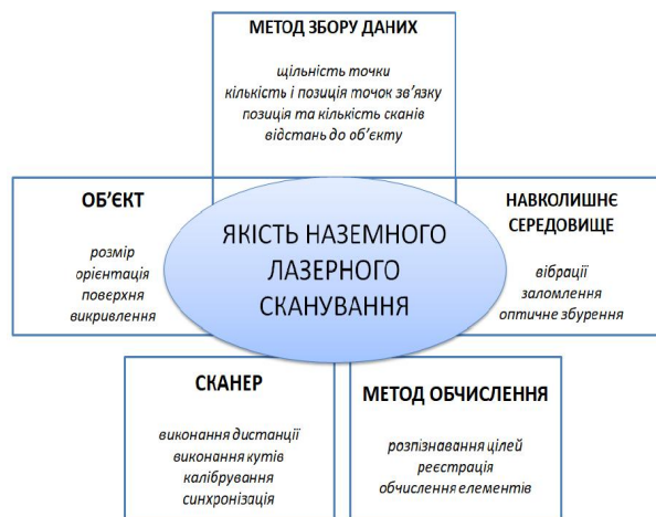
Рис. 2. Модифікована схема параметрів, що впливають на якість сканування [Staiger, 2005]
