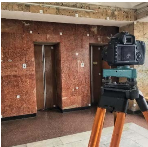
Рис. 4. Стереофотограмметричне знімання полігону контрольних марок неметричною камерою Canon EOS 5D Mark III
