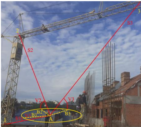
Рис. 3. Ілюстрація вимірювань ЕТ кутів і ліній до точок на баштовому крані
