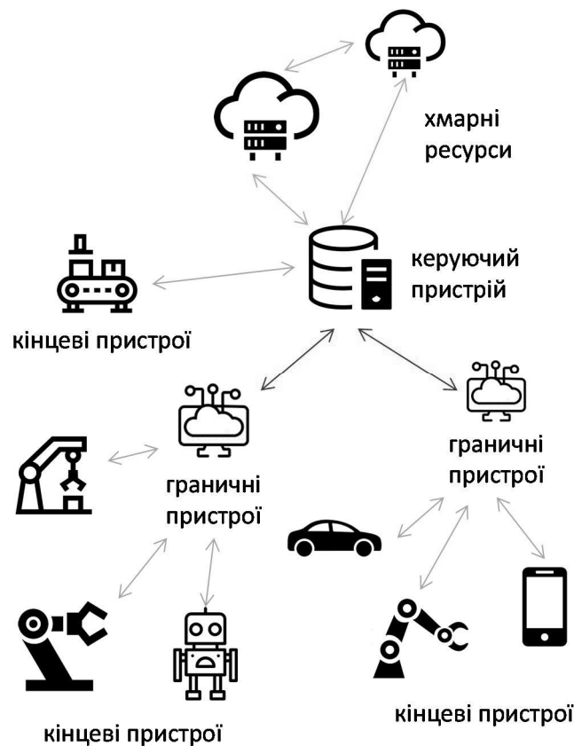
Рис. 2. Схема архітектури систем промислового Інтернету речей із використанням хмарних ресурсів
