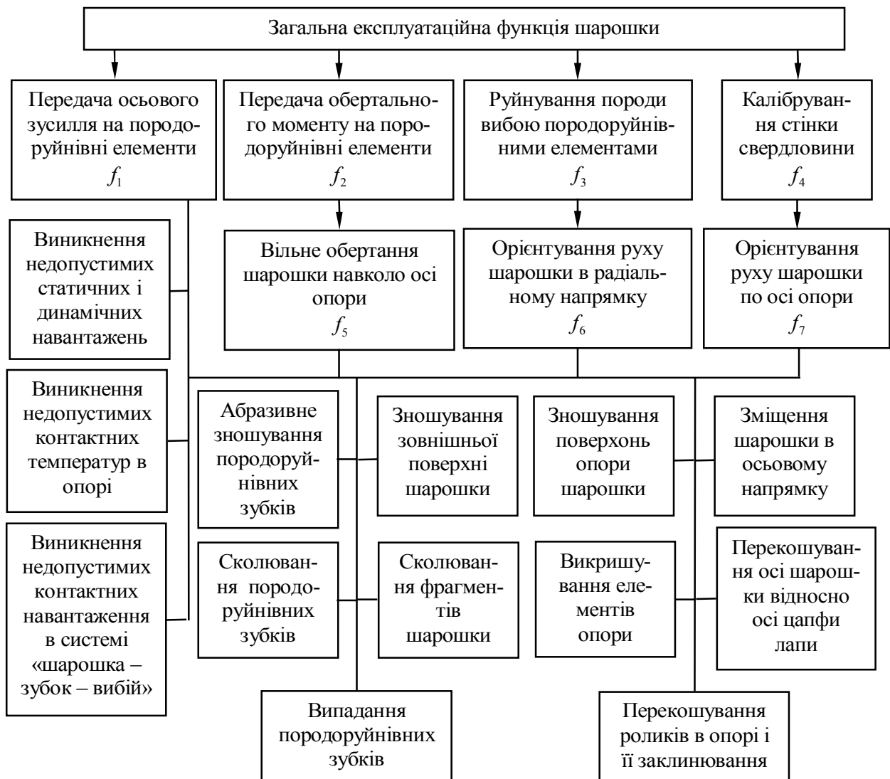
Рис. 3. Граф основних експлуатаційних функцій шарошки з вставним породоруйнівним оснащенням Fig. 3. Diagram of the main operating functions of a roller cutter with insertable rock breaker
