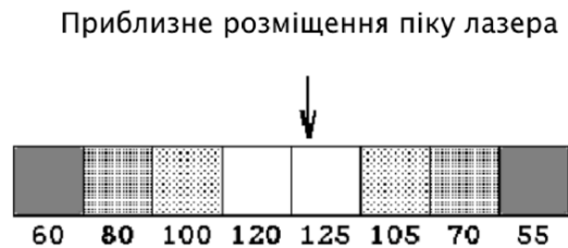
Рис. 1. Типові значення інтенсивності лазерної лінії для суміжних пікселів
