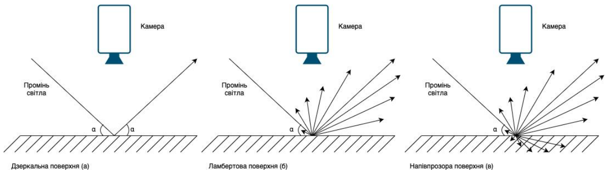
Рис. 2. Поведінка світла, відбитого на дзеркальній поверхні (а), ламбертовій поверхні (б) і напівпрозорій поверхні (в).
