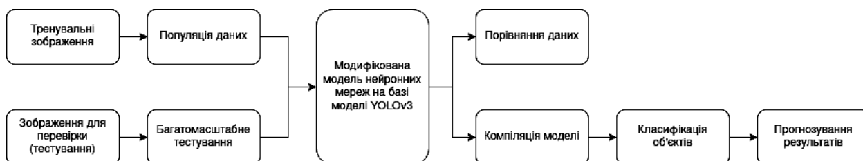
Рис. 2. Функціональна схема інформаційної системи для виявлення об'єктів на зображенні за допомогою модифікованих існуючих моделей.
