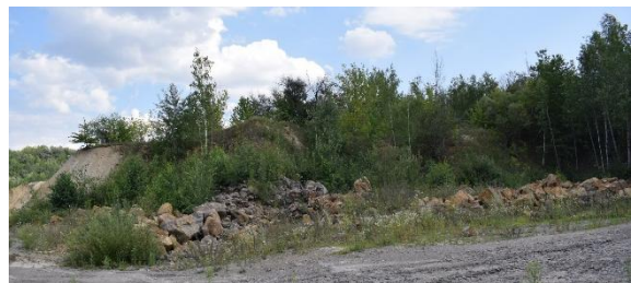
Рис. 5. Утворення насипів на бермі Гніванського кар'єру (на передньому плані – великоуламковий відвал, на задньому плані – відвал розкривних товщ).
