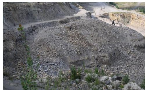
Рис. 3. Висаджена вибуховими роботами маса порід, яку вибирають екскаваторами у Гніванському кар'єрі.
