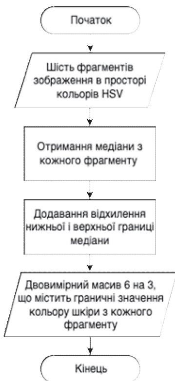
Рис. 7. Блок-схема алгоритму отримання граничних значень кольору шкіри з кожного фрагмента / Diagram illustrating the extraction of boundary values of skin color from each fragment
